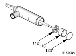
Fig. 7. Valve plate
