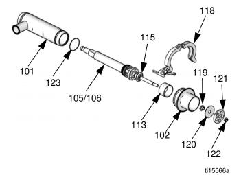
Fig. 2. Remove piston rod
